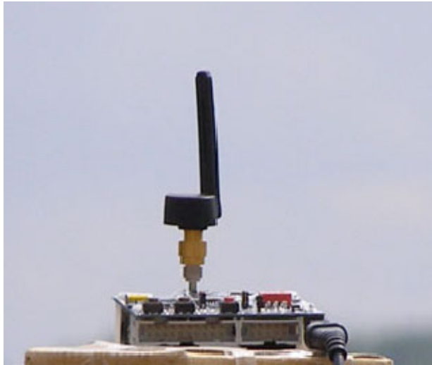
Figura 2: Módulo receptor con antena externa montado en lo alto del trípode.
